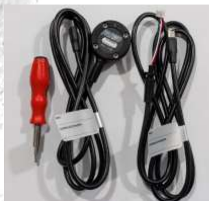
LECTOR CON SU CABLE DE REPUESTO Y HERRAMIENTA PARA SU REEMPLAZO
