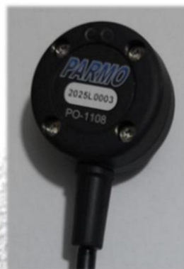
CUENTA CON 2 LED DE COMUNICACIÓN TRANSMISION-RECEPCION (Tx/Rx)
